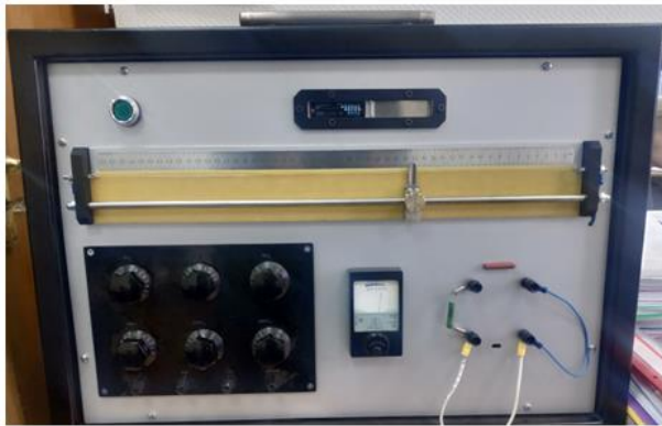
Рисунок 1– Экспериментальные установки для изучения моста Уитстона, изготовленные студентами университета
