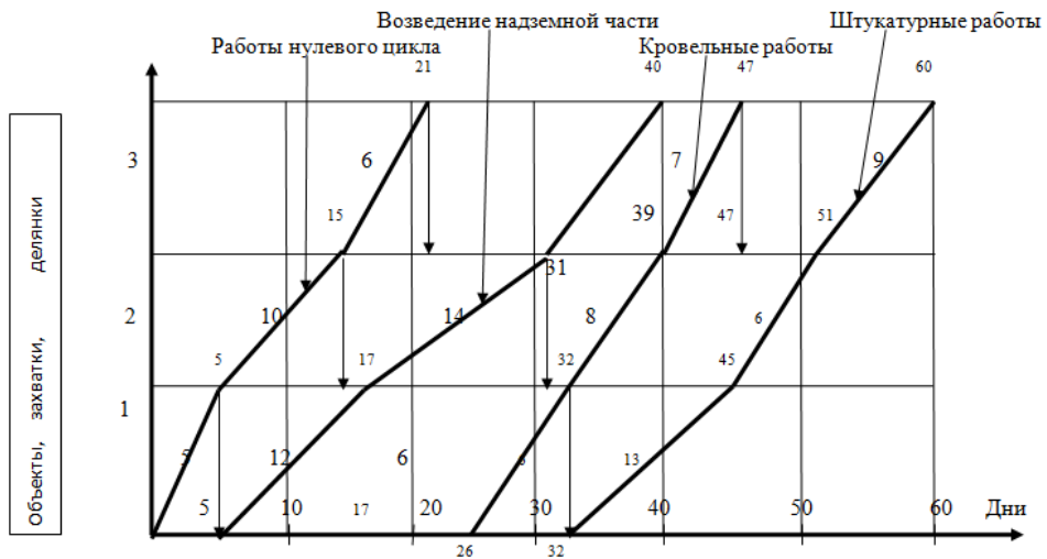
Рисунок 6.2 – Оптимизация операционно-технологического потока движения строительно-монтажного персонала при циклограммном календарном проектировании – оптимизированный вариант
