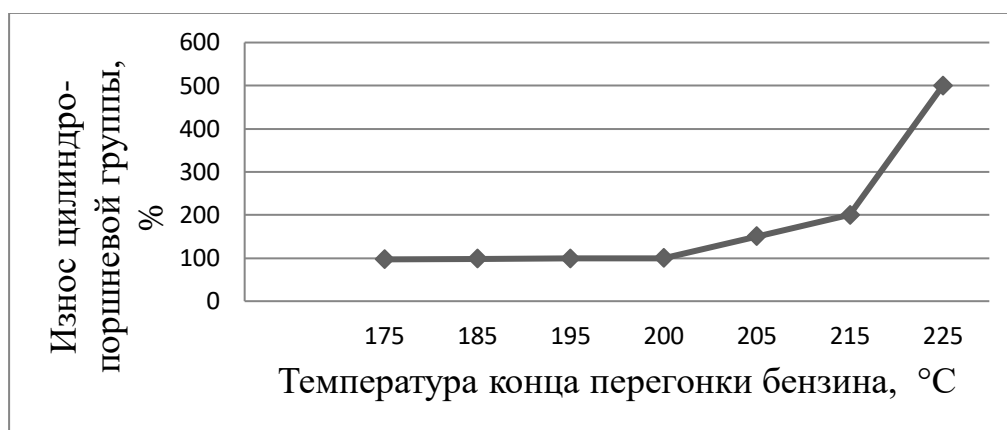
Рис. 2. Влияние температуры конца перегонки на износ цилиндра-поршневой группы
