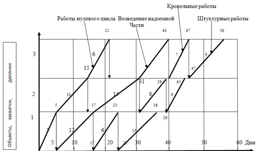
Рисунок 6.1 – Оптимизация операционно-технологического потока движения строительно-монтажного персонала при циклограммном календарном проектировании
