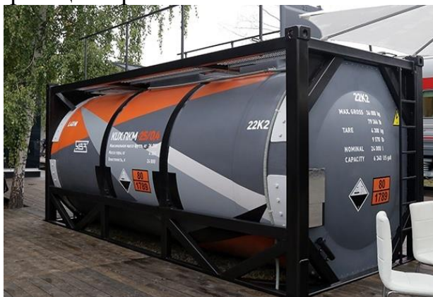
Рисунок 2.Общий вид контейнера-цистерны модели КЦМ-40/07 с сосудом из ПКМ
